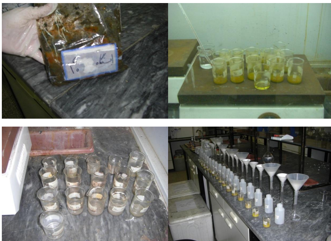
شکل ۲-۶: مراحل هضم اسیدی و ترقیق نمونه‌های رسوب جهت آنالیز میزان فلزات سنگین
