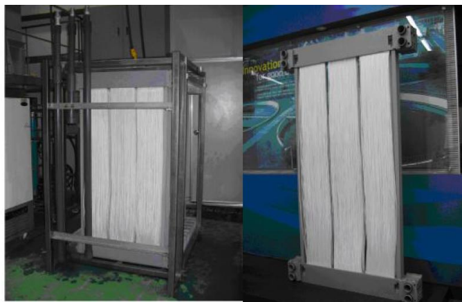
شکل (۱۱-۲): شمایی از مدول های ممبرانی مختلف در قاب های مستطیلی
