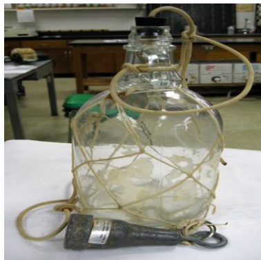
شکل (۲-۲۰): نمونه‌بردار Meyer [مرکز ملی اقیانوس شناسی، ۱۳۸۷]
