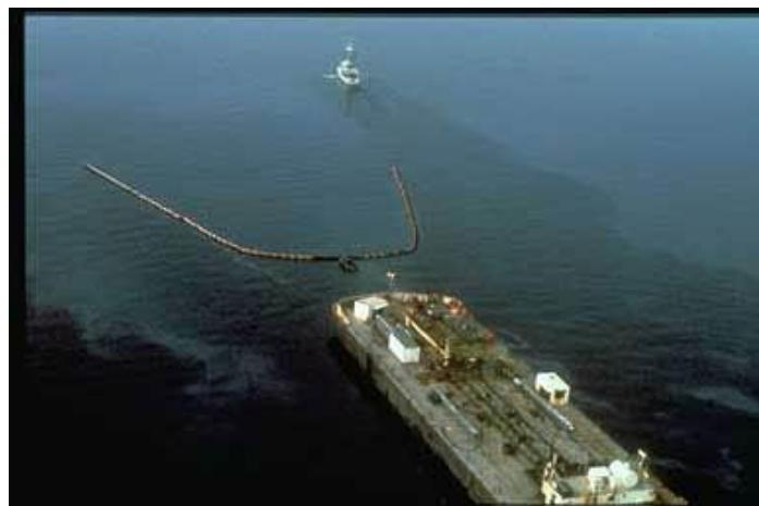
شکل (۴-۲) نمایی از کشتی، اسکیمیر و بومهای آن
